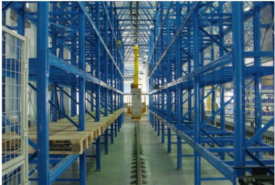
立体仓库选择机械设备类型及相关参数货架：货架的设计是立体仓库设计的一项重要内容，它直接影响到立体仓库面积和空间的利用率。①货架形式：货架的形式有很多，而用在自动化立体仓库的货架一般有：横梁式货架、牛腿式货架、流动式货架等。设计时，可根据货物单元的外形尺寸、重量及其它相关因素来合理选取。②货格的尺寸：货格的尺寸取决于货物单元与货架立柱、横梁（牛腿）之间的间隙大小，同时，在一定程度上也受到货架结构型式及其它因素的影响。自动化立体仓库发展趋势 自动化程度和管理水平不断提高，运转速度加快，出入库能力增强，货物周转率提高。重庆小型立体仓库销售公司
